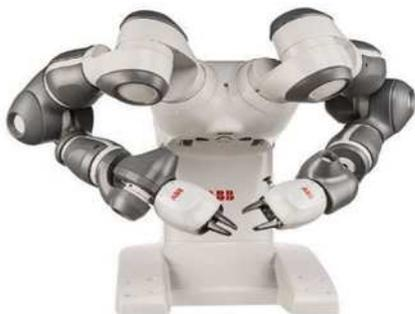
同クラス協働ロボットで最も“器用”といっても過言ではない14軸の動作性能
